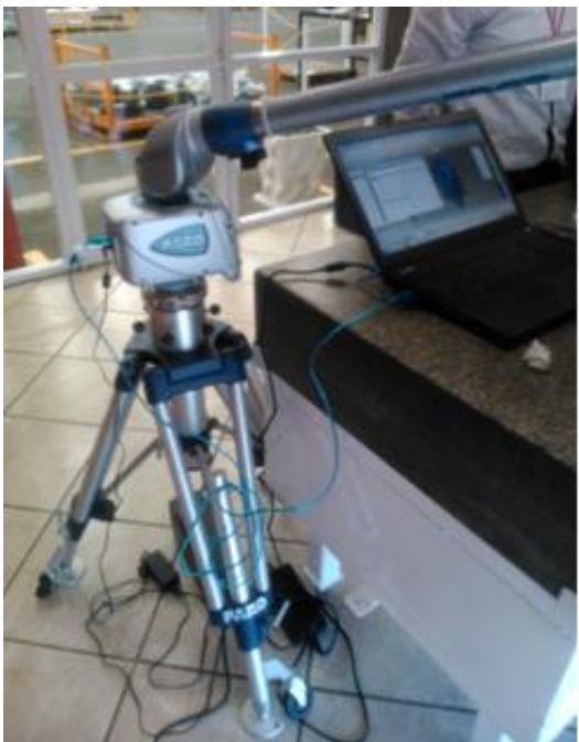
Figura 6.5 Escáner FARO 14000 de brazo articulado.
