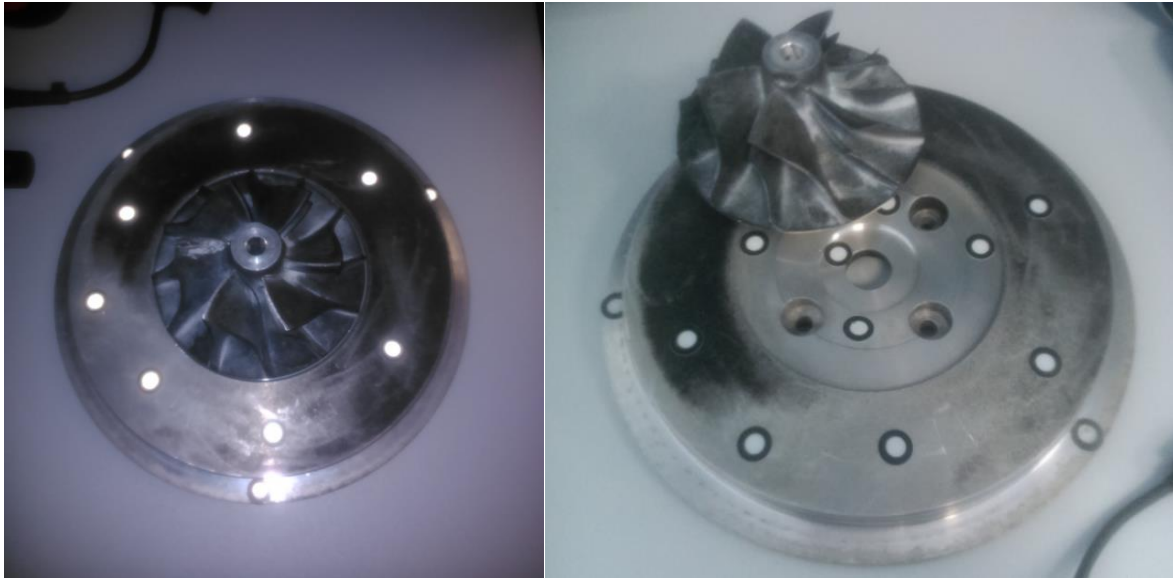
Figura 6.6 Impulsor del compresor y base del difusor con targets para referencia espacial del láser.
