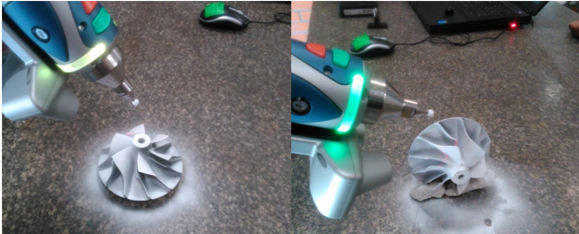
Figura 6.9 Impulsor del compresor escaneado en dos diferentes posiciones.
