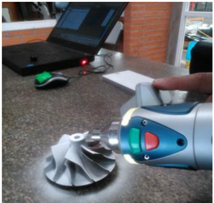
Figura 6.5 Escáner FARO 14000 de brazo articulado.
