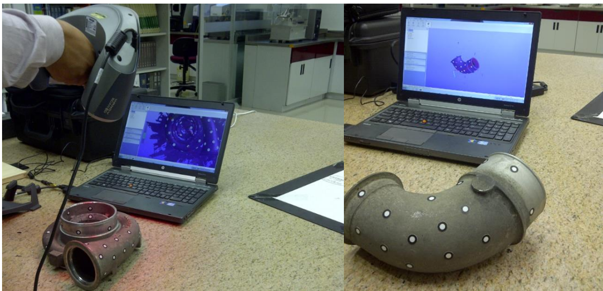
Figura 6.7 Escaneo de la voluta del compresor y ducto de salida.
