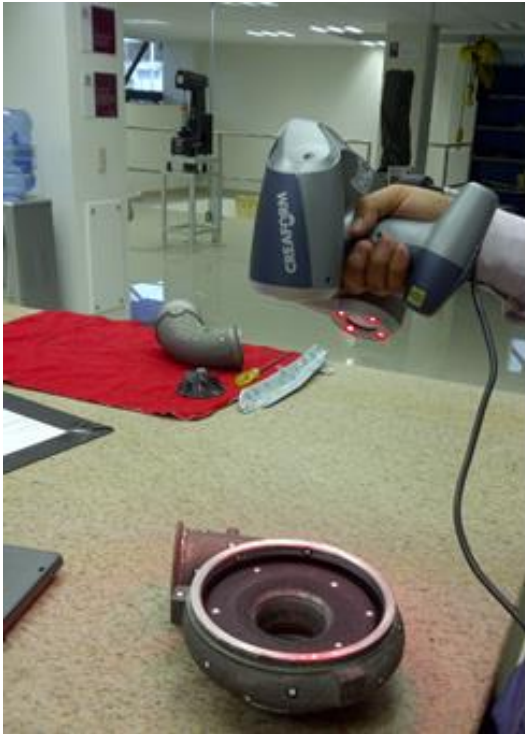
Figura 6.4 Escáner EXAscan con uso de targets .
