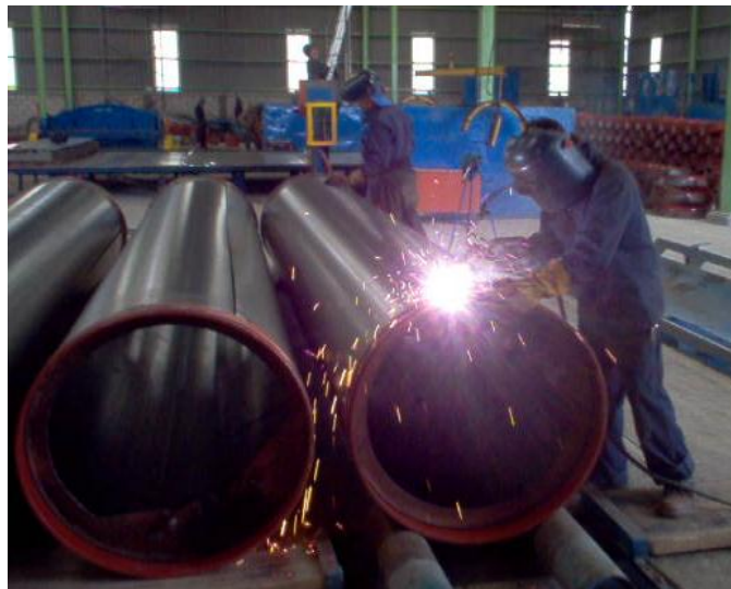
Figura 2. 4 Armado de cilindro con extremidades espiga y campana foto tomada en el taller de anillos y cilindros de la empresa Comecop S.A de C.V.
