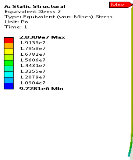
Figura 2. 20 Esfuerzo de Von Mises máximo en concreto interior del tubo sin enchufe.
