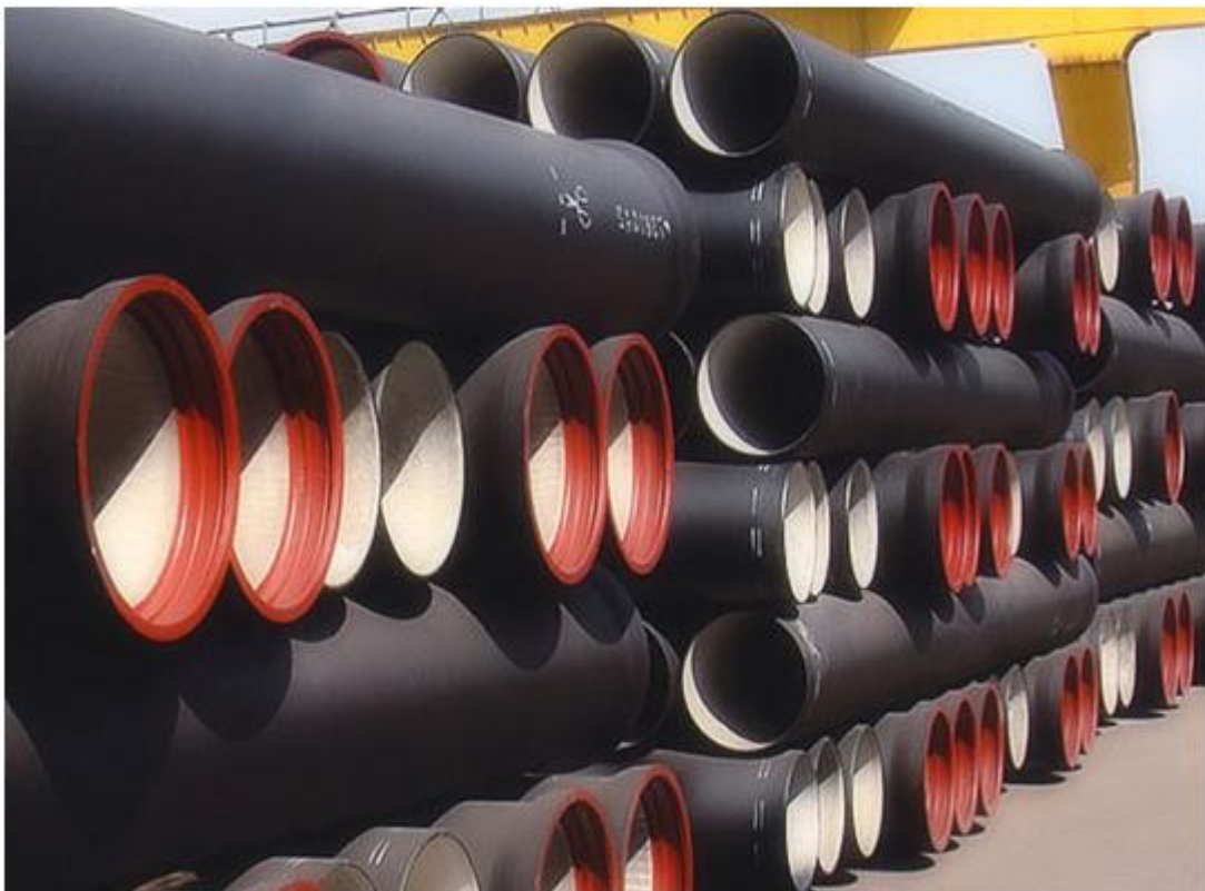
Figura 1. 4 Tubería Hierro Dúctil (HD) tomada en el parque de almacenamiento de la empresa Tubería Moreno.
