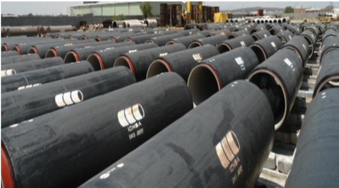
Figura 1. 5 Tubería de Concreto Presforzado con Alma de Acero en patio de almacenamiento de la empresa Comecop S.A de C.V.
