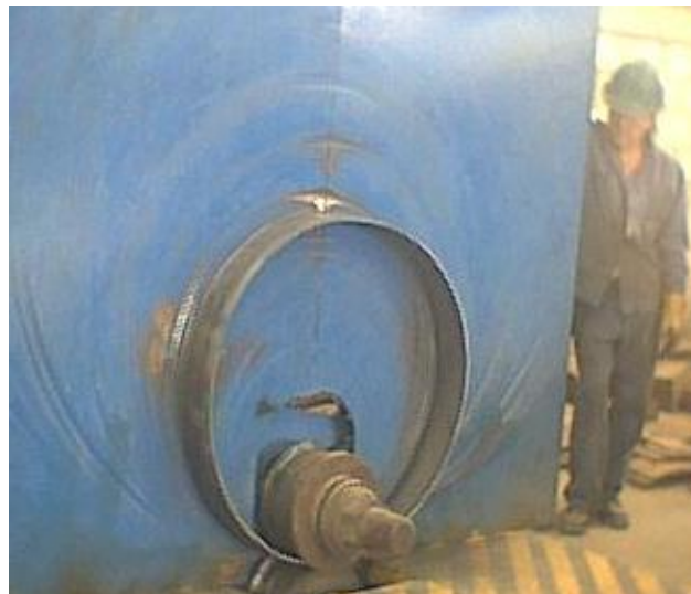
Figura 2. 2 Conformado en frio de extremidad campana por rolado, foto tomada en el taller de anillos y cilindros de la empresa Comecop S.A de C.V.
