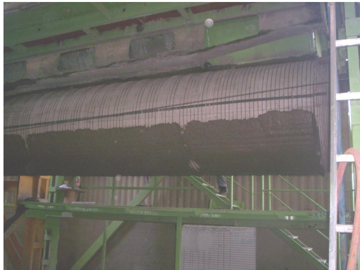
Figura 2. 9 Colocación de revestimiento al tubo para recubrir acero de presfuerzo en máquina de la empresa Comecop S.A de C.V.
