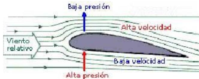
Figura 27 Presión vs velocidad.
