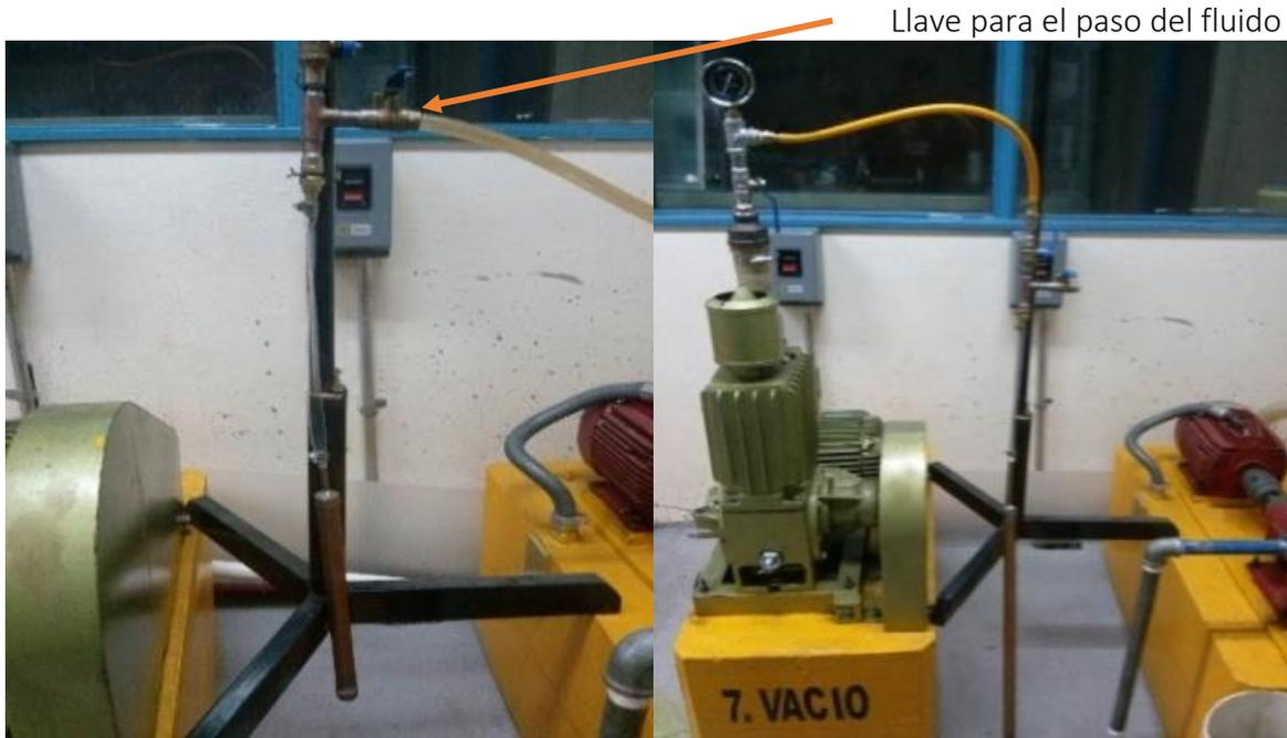
Figura 2.12 Carga del fluido de trabajo.
