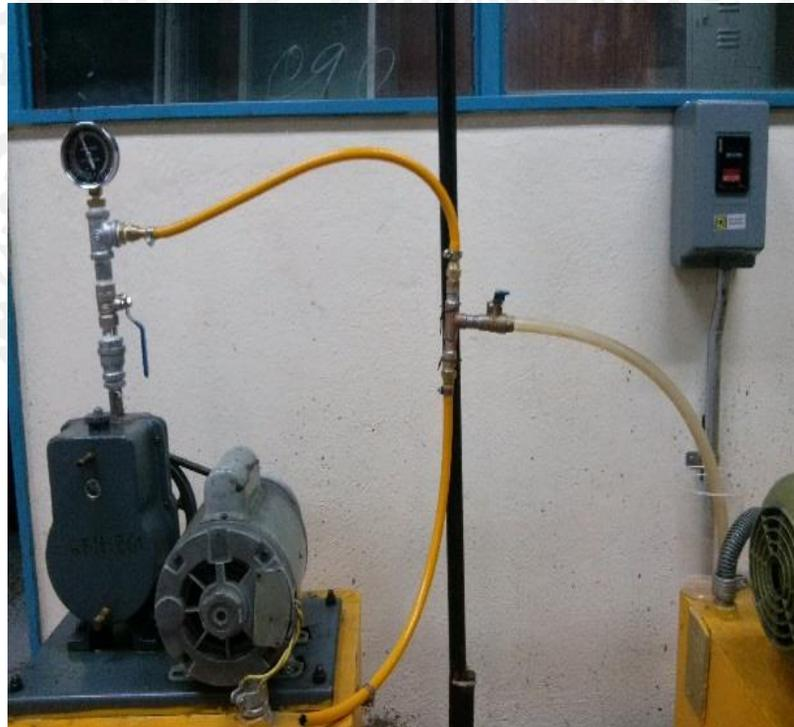
**Figura 2.10** Instalación para generación del vacío en los TTB
