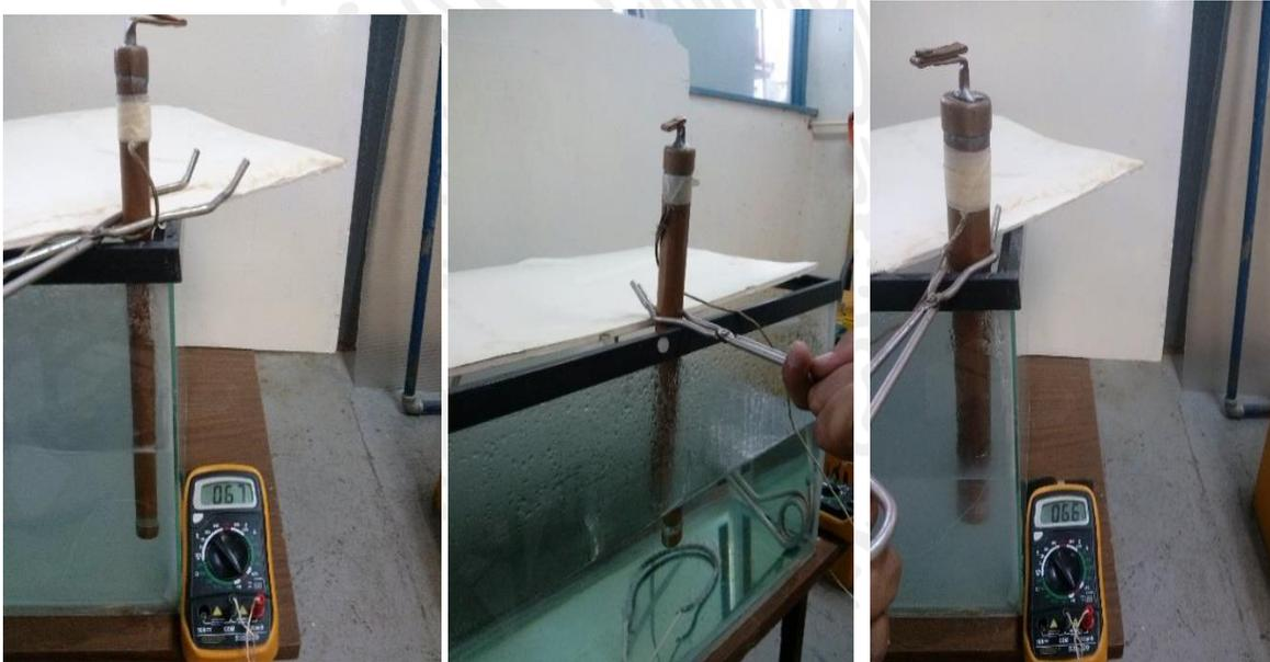
**Figura 2.15** Pruebas de calentamiento de los tubos termosifones bifásicos.
