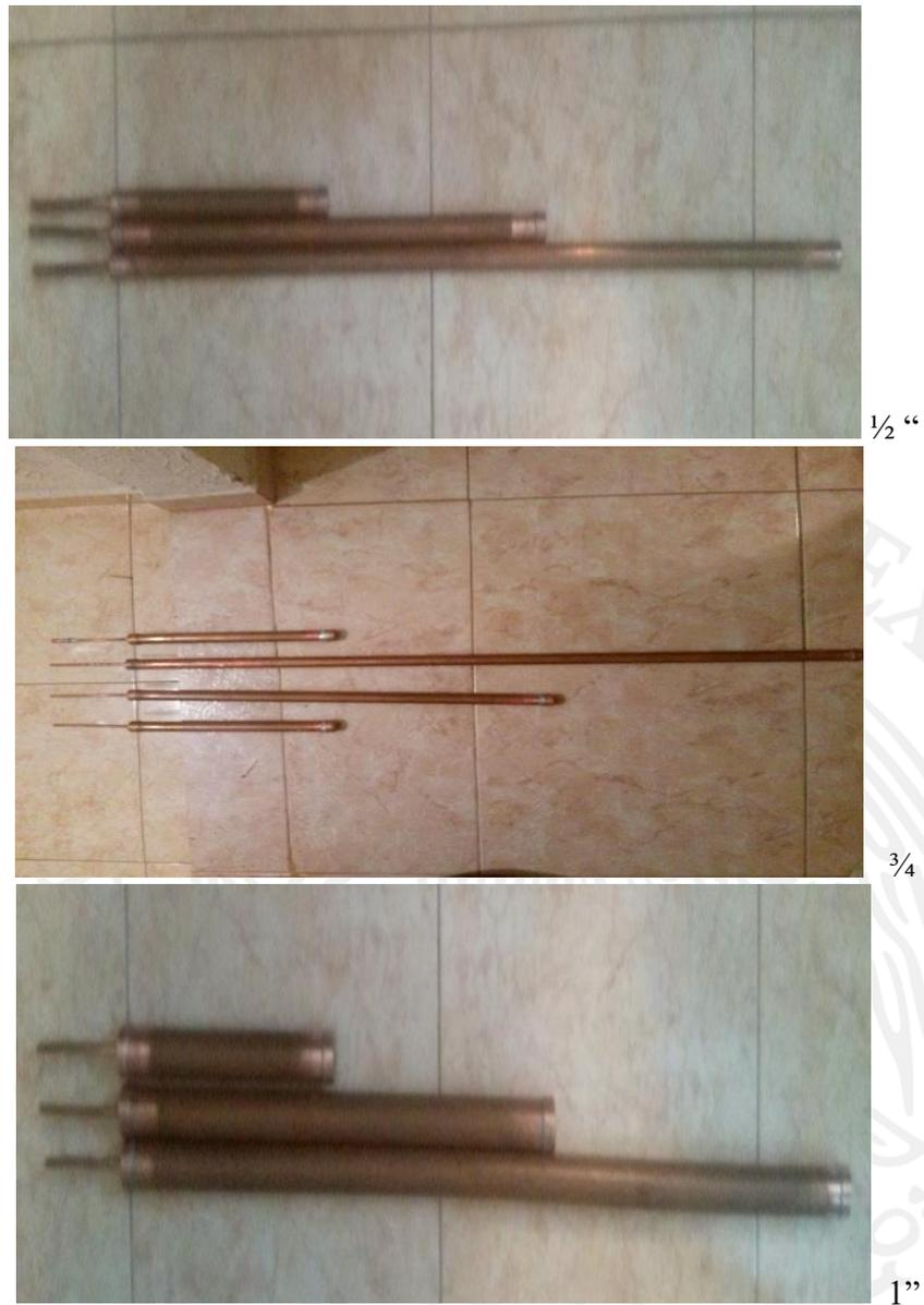
**Figura 2.8** Tubos termosifones bifásicos ensamblados.
