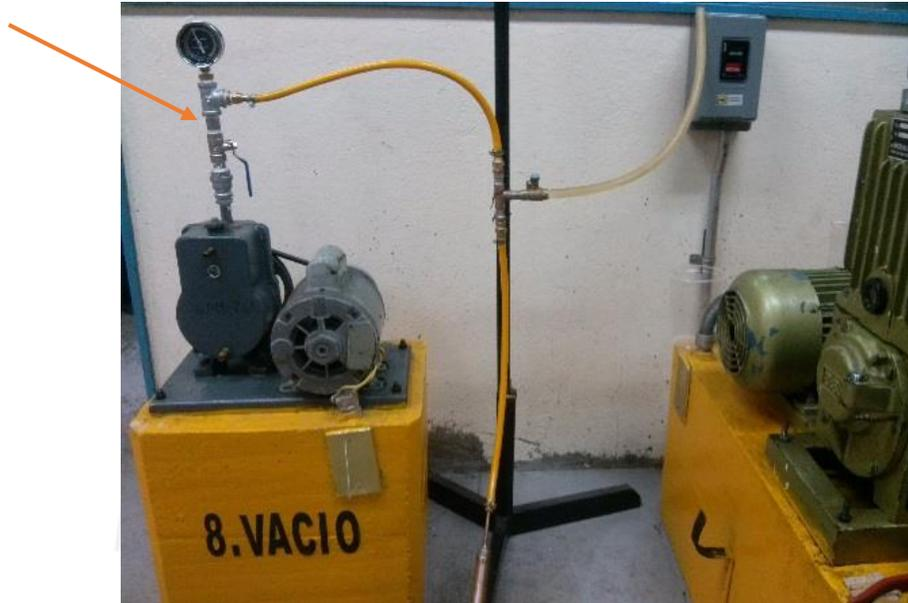
**Figura 2.11** Generación de vacío.
