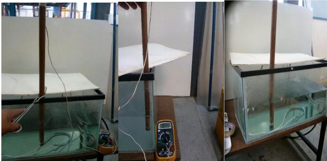
**Figura 2.16** Pruebas de calentamiento de los tubos termosifones bifásicos.
