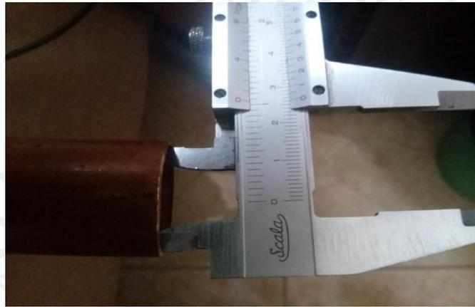
**Figura 2.4** Medición del tubo de 1" de diámetro
