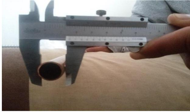
Figura 2.2 Medición del tubo de  $\frac{1}{2}$ " de diámetro
