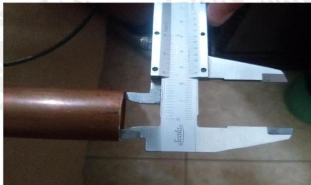
Figura 2.3 Medición del tubo de  $\frac{3}{4}$ " de diámetro
