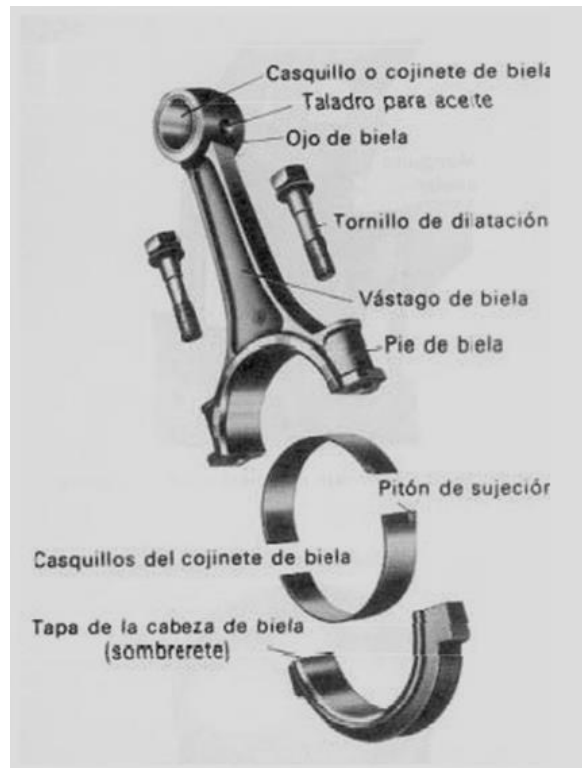
Figura. 7. Partes de la biela
