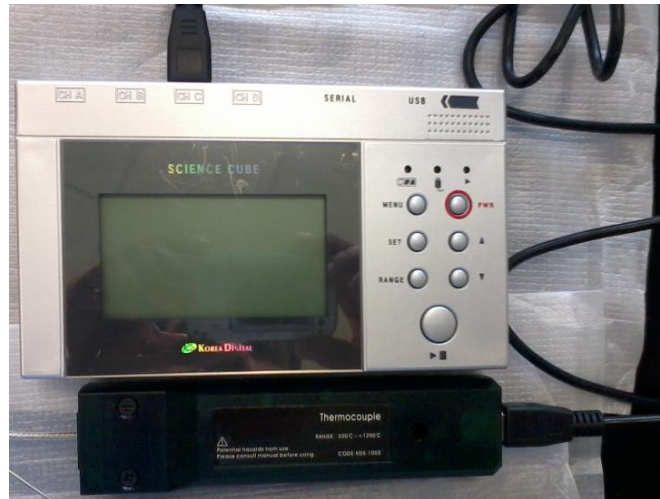
Figura 39: Sensor de temperatura, marca Science cube y Termocople
