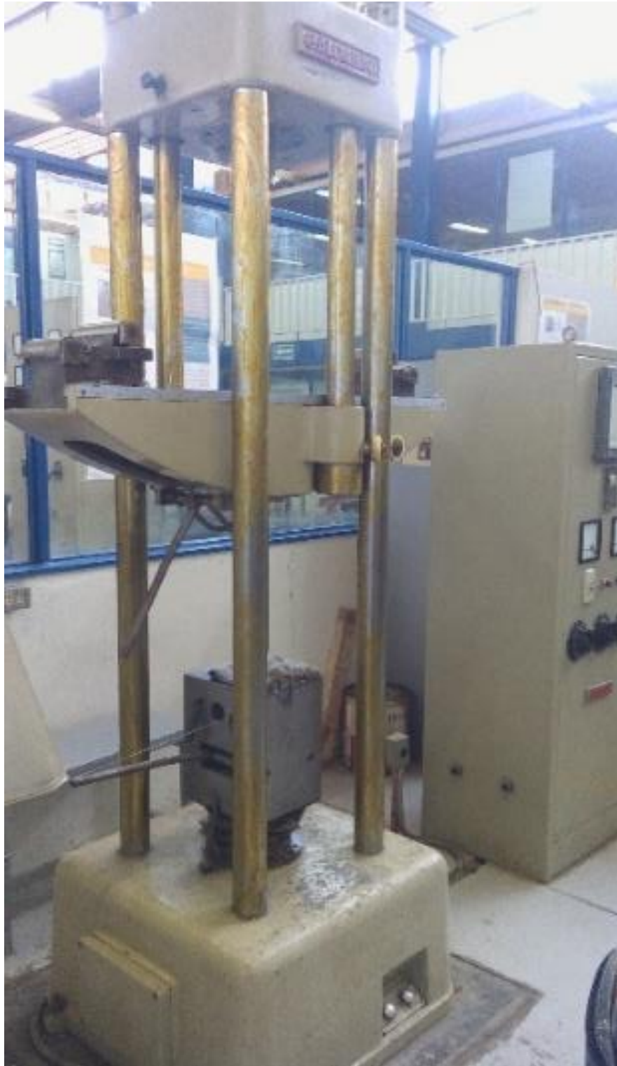
Figura 3-8. Máquina universal para pruebas de tracción, compresión y flexión, (Laboratorio de pruebas destructivas del ITPachuca).
