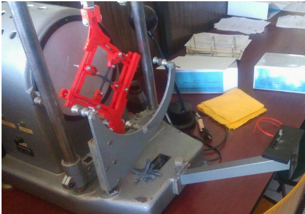
Figura 4-8. Ensayo de tracción de una probeta en el dispositivo.
