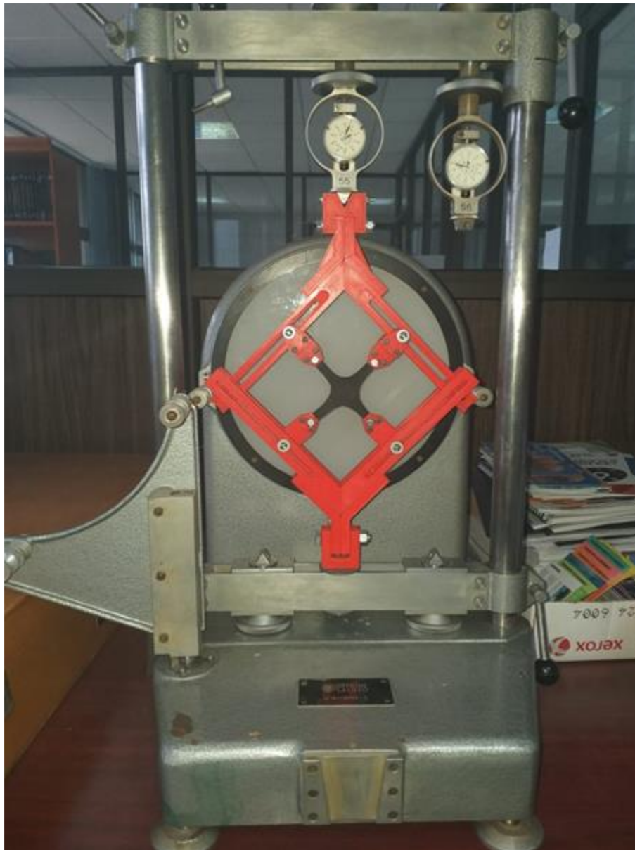
Figura 4-6. Dispositivo para pruebas biaxiales montado en el marco metálico.
