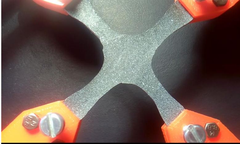
Figura 4-7. Probeta moteada y montada en las mordazas del prototipo
