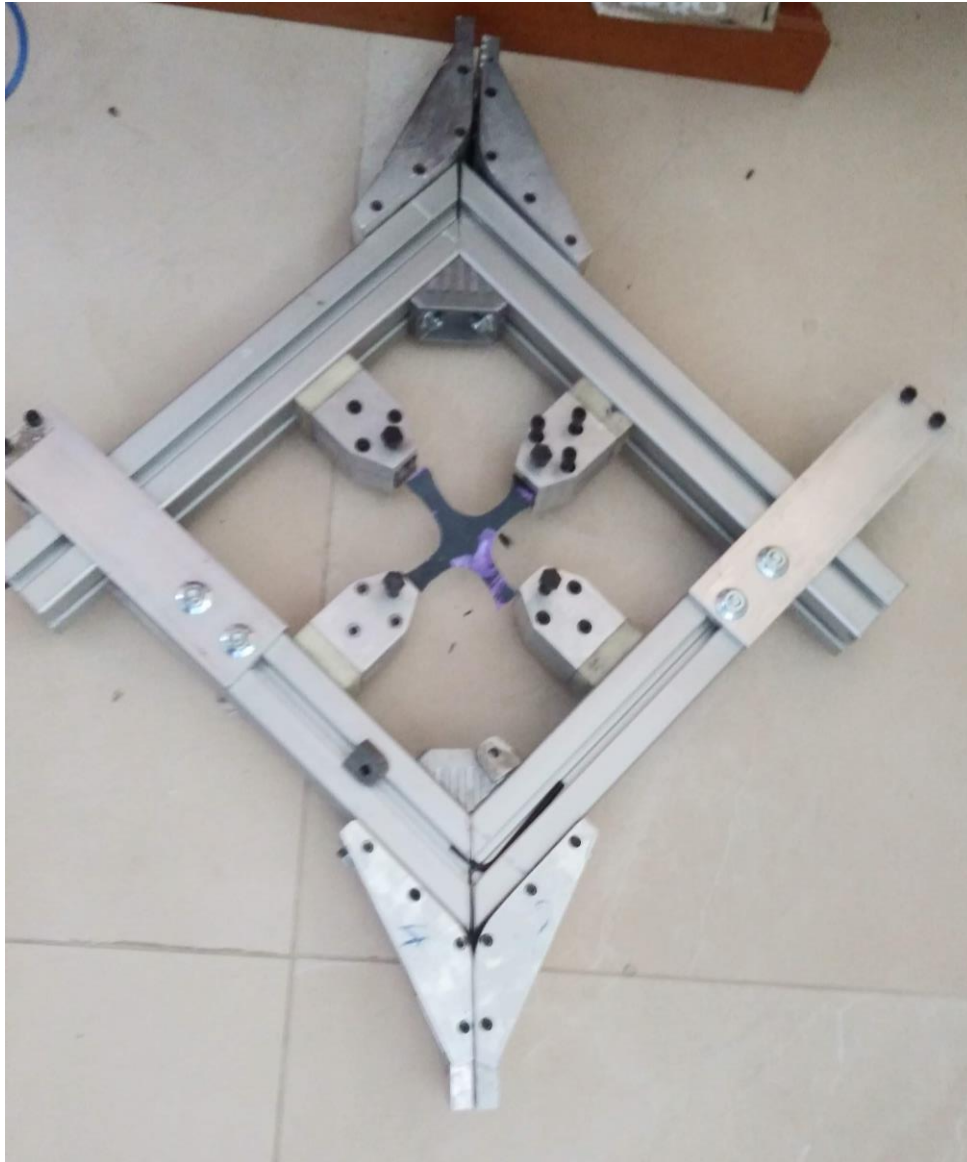
Figura 4-12. Ensamble final del dispositivo de pruebas biaxiales.
