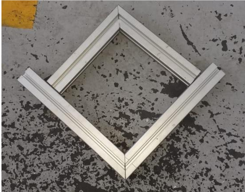
Figura 4-10. Marco de perfil Bosch para el dispositivo de pruebas biaxiales.
