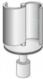
*Figura 2. Aerogenerador Savonius.*
