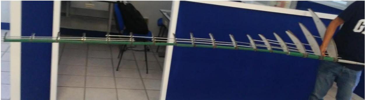
*Figura 64. Estructura de pala fijada desde la flecha de ensamble al buje.*
