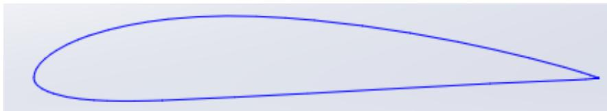
*Figura 29. Perfil aerodinámico de la primera estación.*
