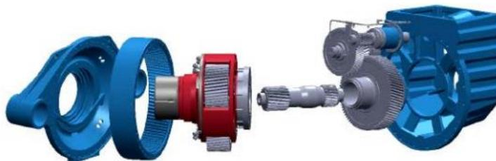
Figura 69. Multiplicador de velocidad planetario de un generador eólico.
