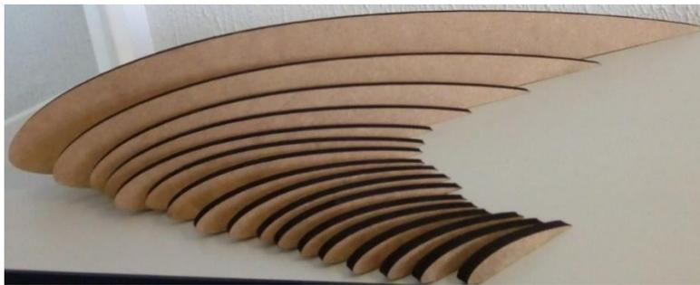
*Figura 61. Perfiles cortados con CNC, vista lateral.*
