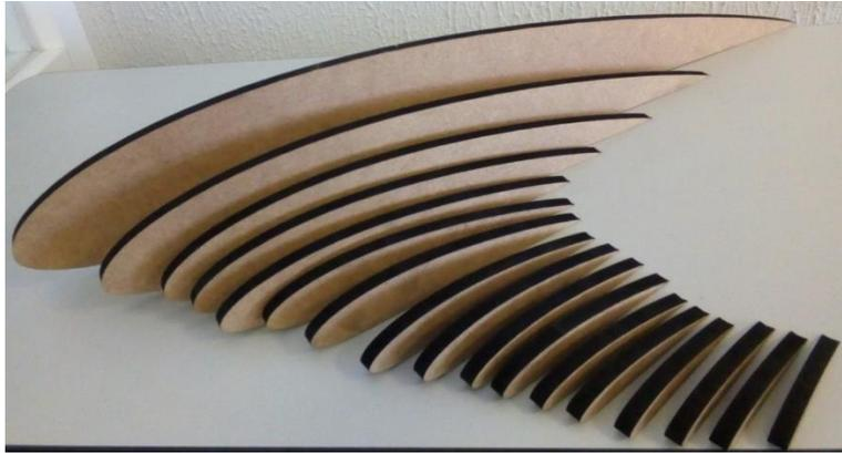
*Figura 60. Perfiles cortados con CNC.*
