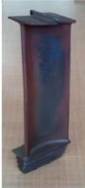
Figura 20. Álabe rotor de primera etapa de turbina.
