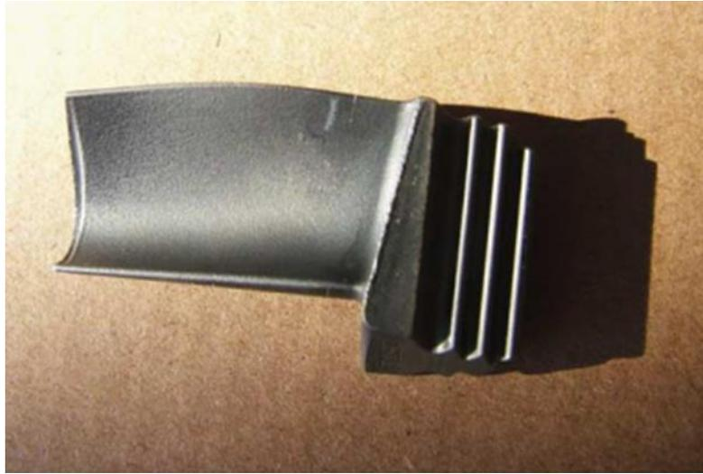
Figura 5. Falla ocasionada por fatiga en álabes de turbina [2.12].
