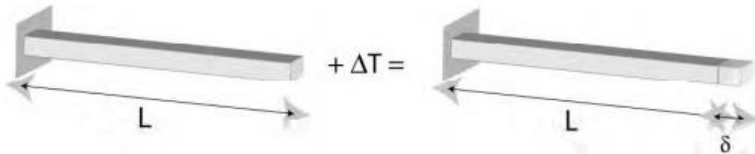
Figura 14. Dilatación producida por diferencial de temperatura [3.10].
