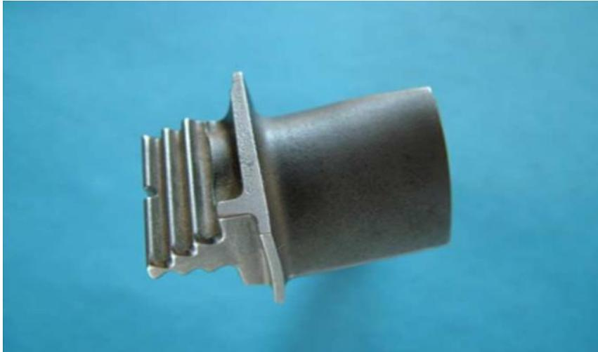
Figura 4. Geometría típica usada en álabes de turbina [2.12].
