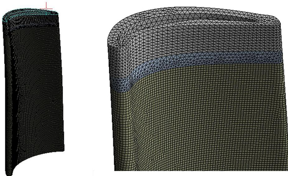
Figura 41. Malla no conforme en el dominio sólido.
