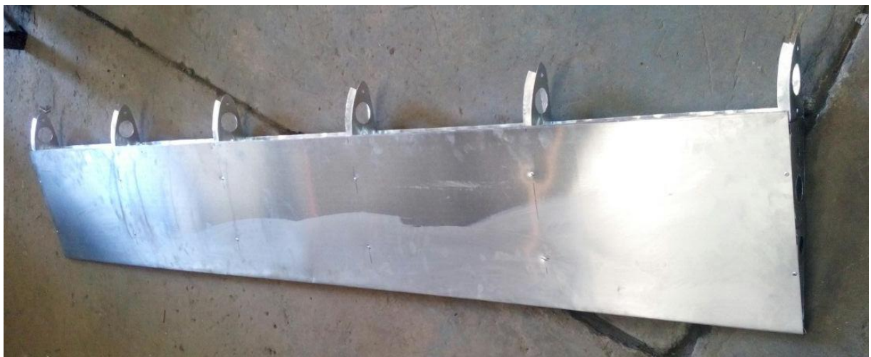
Figura 32. Ensamble de la cubierta exterior con la estructura interior.
