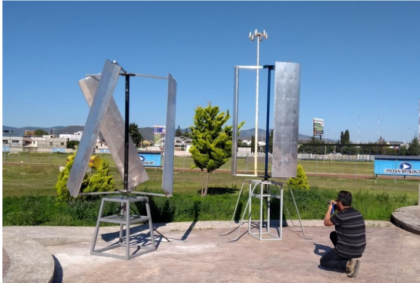
Figura 38. Instalación de prototipos para pruebas
