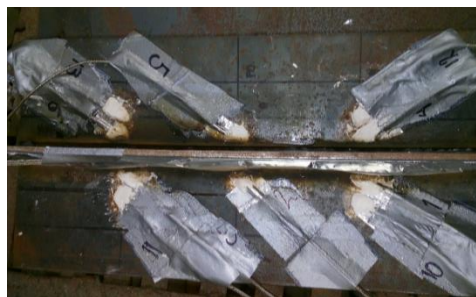
Figura 36.- Elemento Estructural soldado con termopares por el Proceso GMAW
