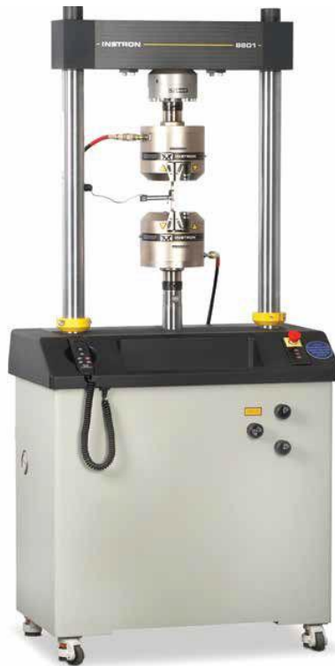
Figura 22. Máquina servo-hidráulica utilizada en el ensayo de fatiga de las probetas de aluminio de Al6061-T6.
