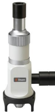
Figura 23. Microscopio utilizado en la medición de longitud de grieta
