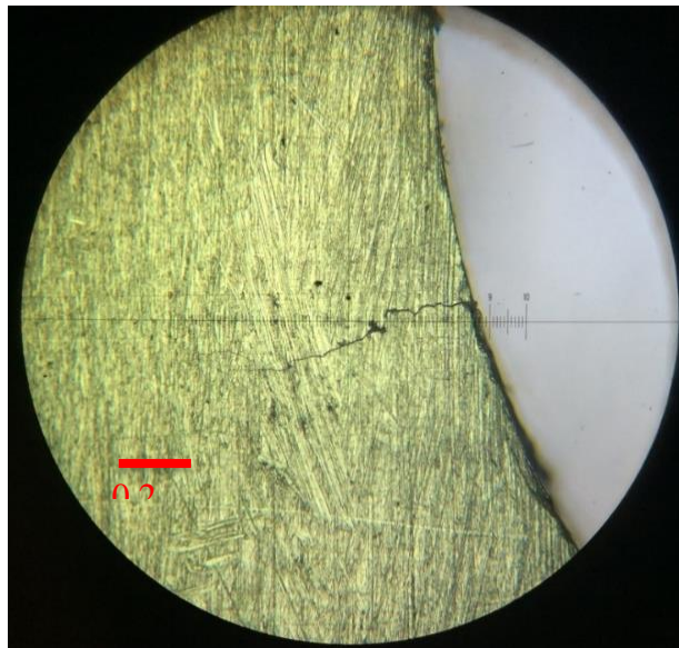
Figura 31. Medición de la longitud de pre-grieta y grieta con el microscopio Struers®.
