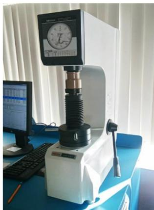
**Figura 54.** Durómetro modelo HR-100 empleado en el análisis de dureza HRC
