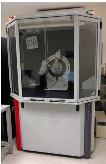
**Figura 56.** Diffractómetro modelo D8 FOCUS empleado en el análisis de DR-X.
