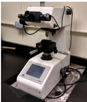
**Figura 55.** Durómetro modelo FM-7 empleado en el análisis de microdureza.
