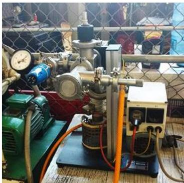
**Figura 61.** Equipo empleado para encapsular las muestras para Tratamiento Térmico
