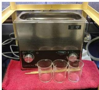
**Figura 58.** Equipo Transsonic 460/H, empleado para baño ultrasónico
