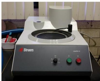
**Figura 57.** Máquina Struers Labopol-5 empleada para la preparación metalográfica
