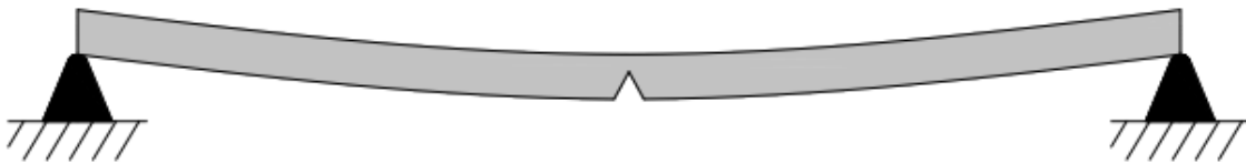
Fig. 3.6 Fisura abierta al máximo debido a la acción de la gravedad y a la posición de la propia fisura.
