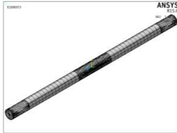
Figura 112. Malla del modelo de elemento finito de rotor fisurado para una relación de a/D = 0.5 y a/b = 0.5
