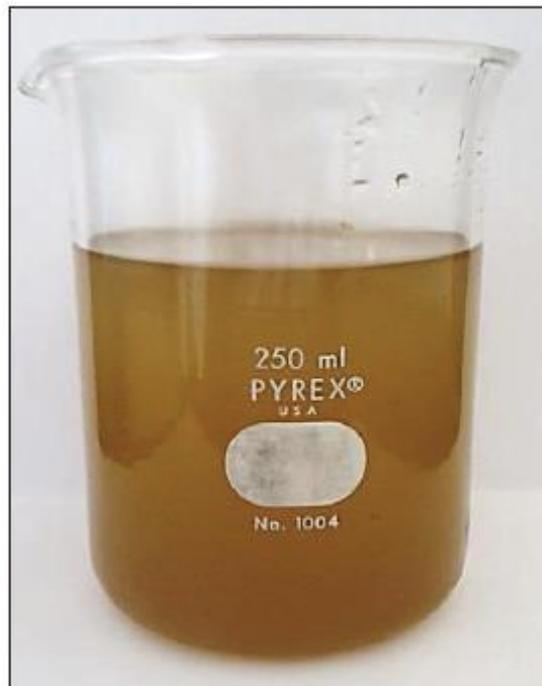
**Figura 2.9 - Aceite de ricino extraído mediante el proceso de prensado hidráulico.**
