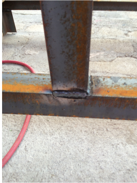
Figura 5.6: Cordón aplicado en horizontal con movimiento en C.
