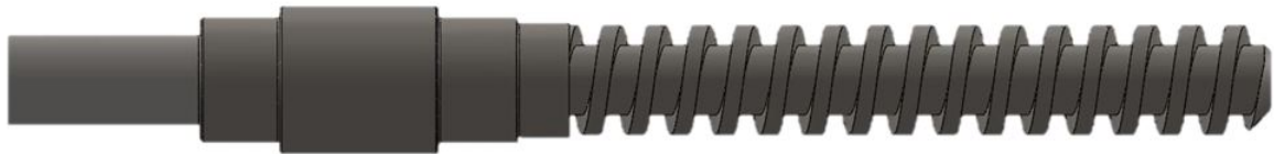
Figura 2.9: Modelo CAD del husillo propuesto
