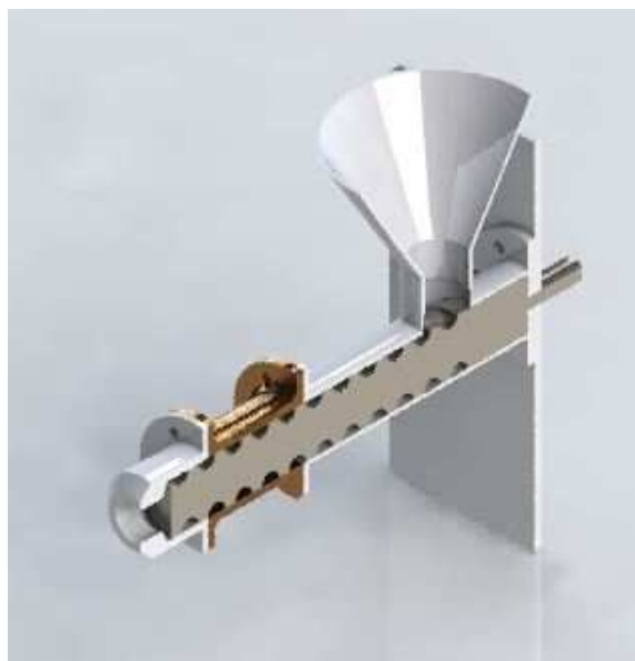
Figura 5.1: Diseño conceptual del prototipo, donde se muestra el husillo y filtro del barril.
