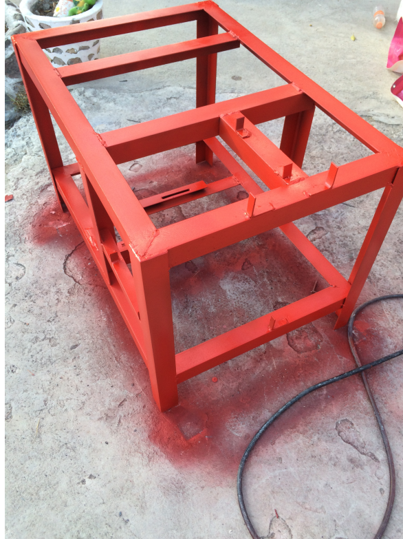
Figura 5.14: Marco pintado con soportes para los canales recolectores.
