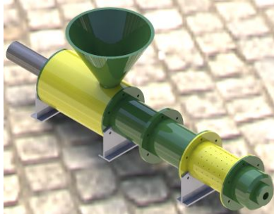
Figura 9: Diseño propuesto del equipo, en el que se observa el filtro de aceite y que la máquina se basa en un diseño modular.
