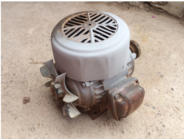
Figura 5.10: Primera mano de primer en la guarda del ventilador del motor.
