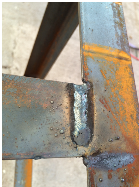
Figura 5.5: Cordón aplicado en plano con movimiento en C.
