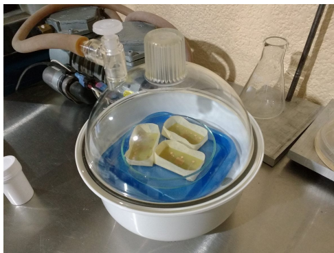
FIGURA 4.22: PDMS sometido a vacío para retirar burbujas de aire
