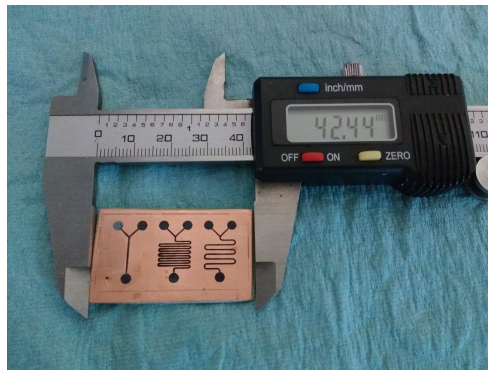
FIGURA 4.20: Molde para microcanales previo a grabado
