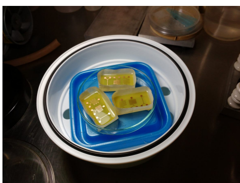
FIGURA 4.23: PDMS al termino del curado
