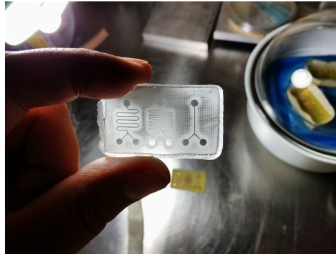
FIGURA 4.25: Microcanales de PDMS desmontados del molde
