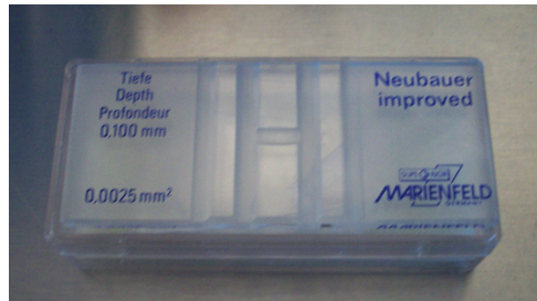
FIGURA 3.5: Cámara de Neubauer
