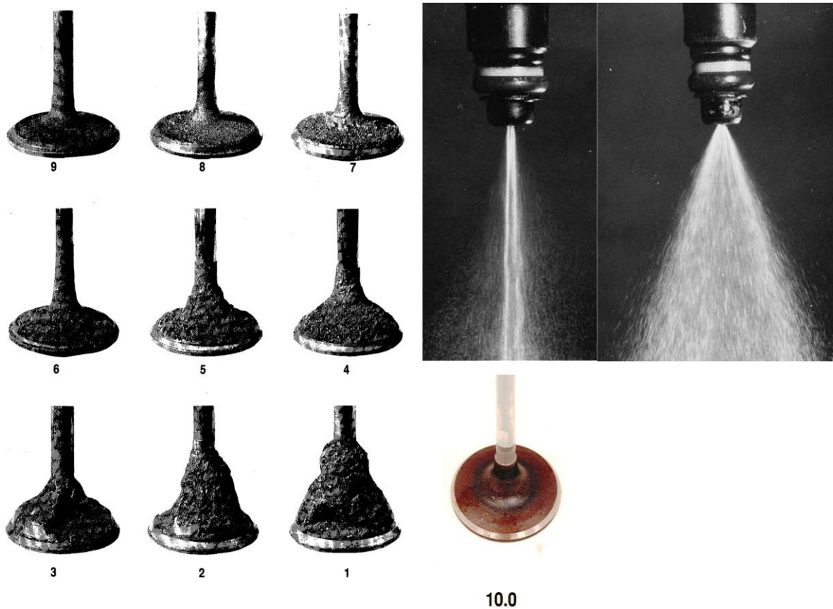
Figura 1. Afectación a causa de la formación de depósitos en válvula de admisión e inyector de combustible
