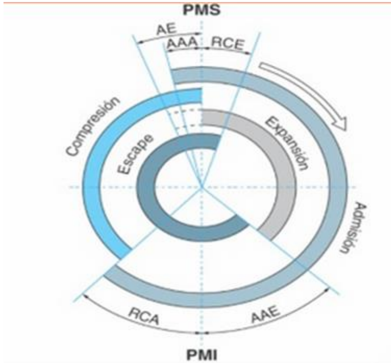
Figura 9. Diagrama de la distribución de ciclos real
