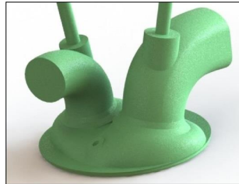
Figura 3 Modelo para el análisis de flujo de la cámara de combustión del motor Ford Ranger 2.31 modelo 94 en línea.
