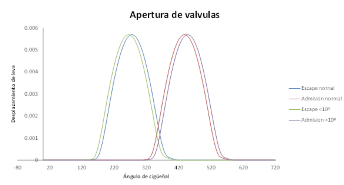
Figura 55. Desplazamiento de válvulas
