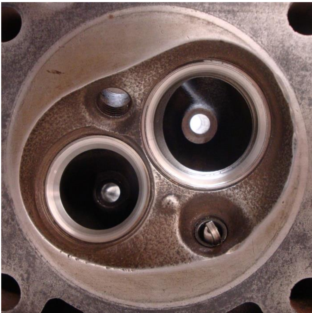
Figura 30. Cámara de combustión Ford Ranger (Instituto Mexicano del Petróleo (IMP)).
