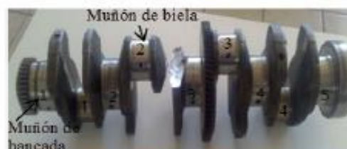
Figura 1. Cigüeñal fracturado MWM-Acteon 4.12 TCE
