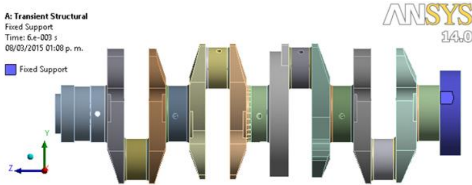
Figura 2.7 Condición de frontera fija en el extremo del cigüeñal
