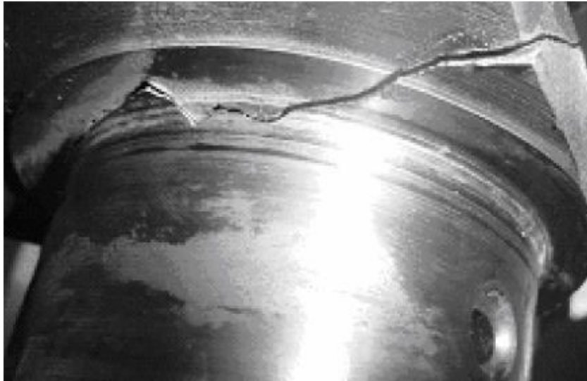
Figura1.2. Vista de la grieta de fractura en el muñón de biela.
