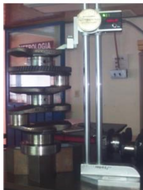
Figura 3. Medición de la longitud del primer segmento fracturado.
