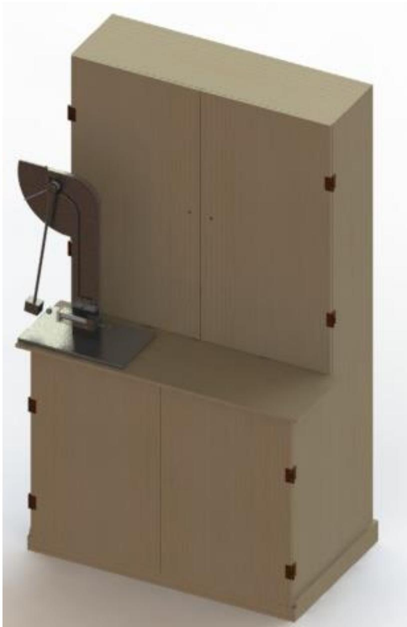
**Figura 5. 17** Péndulo balístico en el banco de pruebas.
