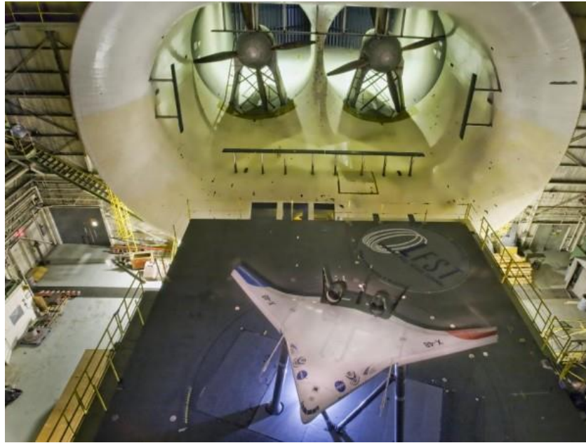
Figura 19. Prueba Aerodinámica a la nave X-48B en el túnel aerodinámico hipersónico de la NASA (Langley's Full-Scale Tunnel).
