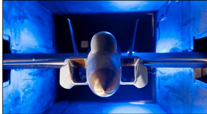
Figura 18. Prueba Aerodinámica realizado por Boeing, de un modelo del caza F-15SE en un túnel aerodinámico supersónico.
