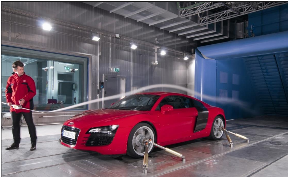
Figura 16. Túnel aerodinámico subsónico de circuito cerrado de AUDI.
