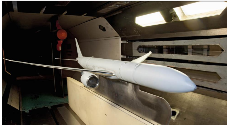
Figura 17. Prueba aerodinámica de un modelo del Boeing 777X en un túnel aerodinámico transónico.
