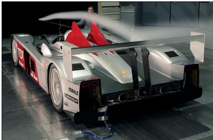
Figura 11. Cámara de ensayo de un túnel aerodinámico de circuito cerrado probando el alerón de un auto de carreras.
