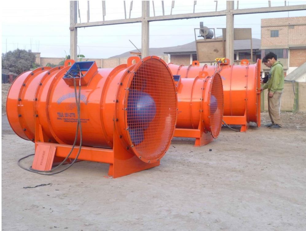
Figura 2. Ventilador axial para un túnel aerodinámico.
