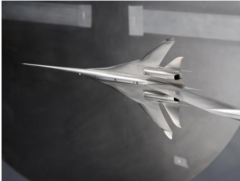
Figura 10. Cámara de ensayo de un túnel aerodinámico de circuito abierto Con prototipo de un avión de combate.
