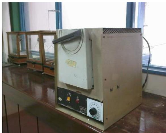
Figura 2.4 Horno de laboratorio Modelo 51848 para tratamientos térmicos
