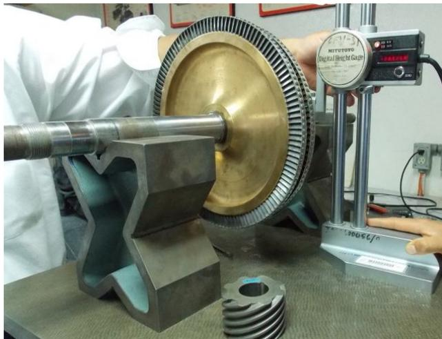
Figura 1.4 Impulsor de la turbina de vapor Coppus TF-12.
