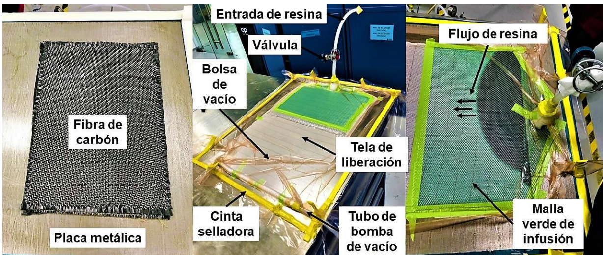
Figura 36. Proceso de fabricación de laminados compuestos por infusión.
