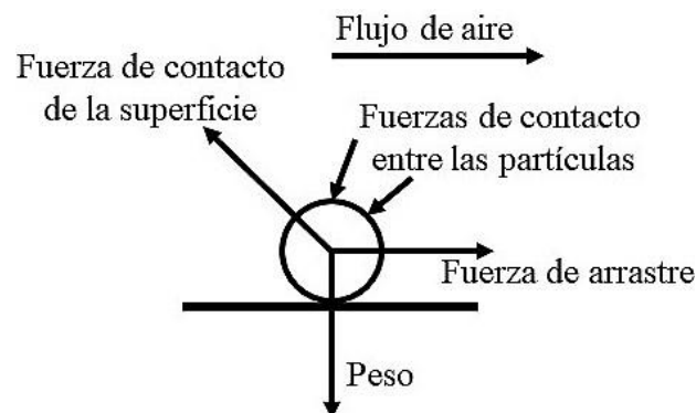
Figura 5. Fuerzas de contacto partícula-superficie [24].
