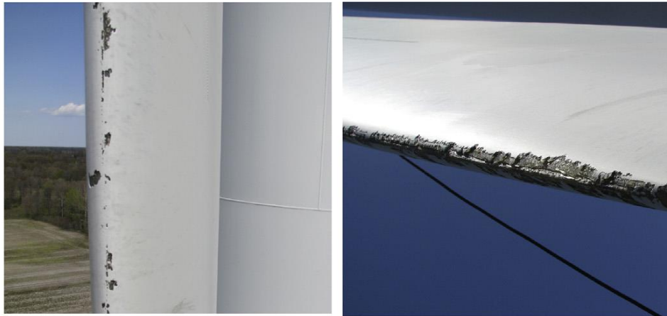
Figura 1. Ejemplo de erosión en palas de aerogeneradores [3].
