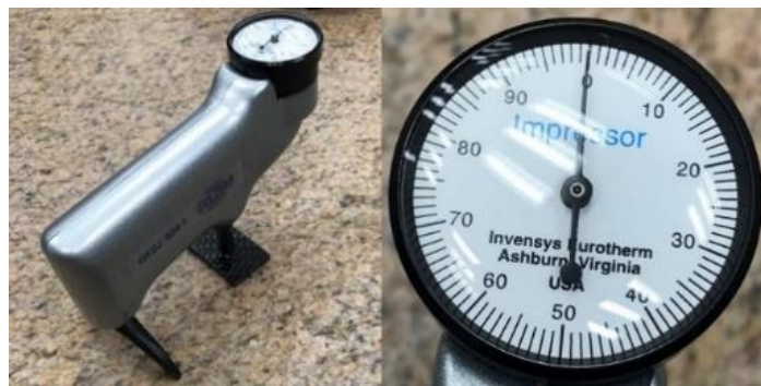
Figura 24. Ensayo de dureza en fibra de carbono.
