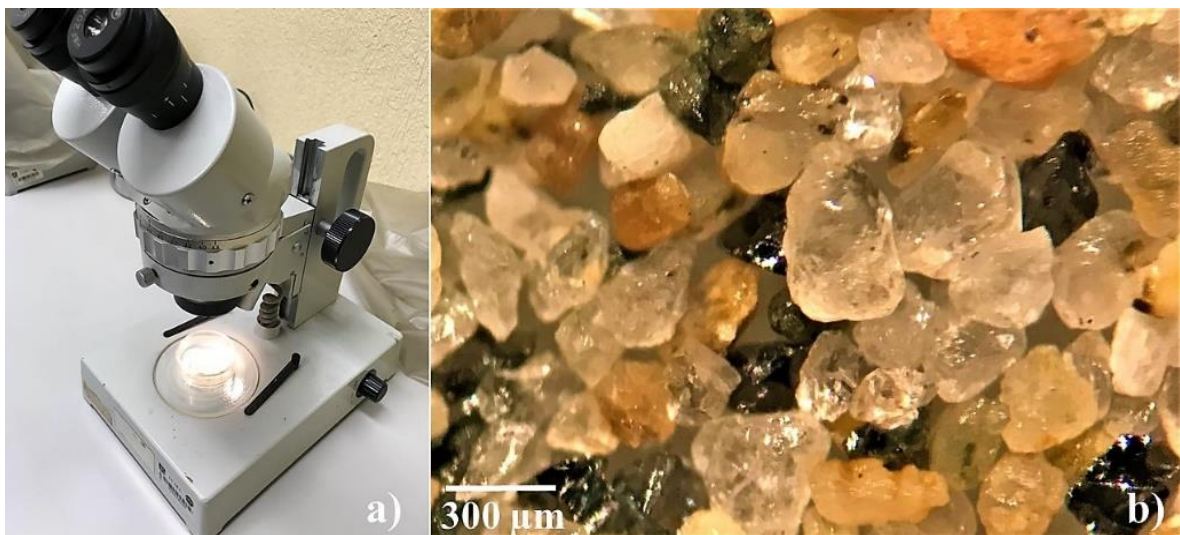
Figura 27. Microscopia de morfología de la partícula erosiva (arena de mar).
