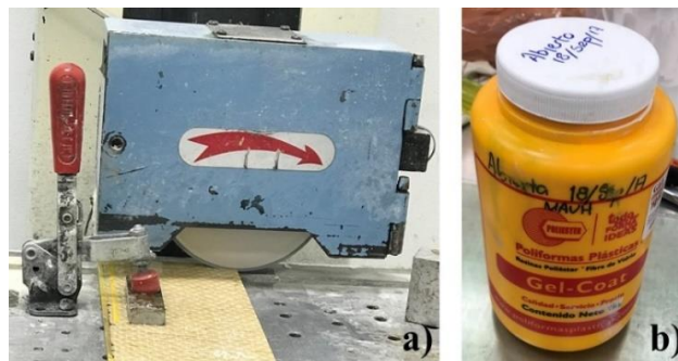
Figura 22. a) Cortador de disco de diamante y b) Recubrimiento Gelcoat.
