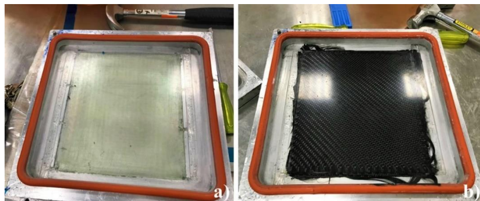
Figura 21. a) Laminado de fibra de vidrio y b) Laminado de fibra de carbono.
