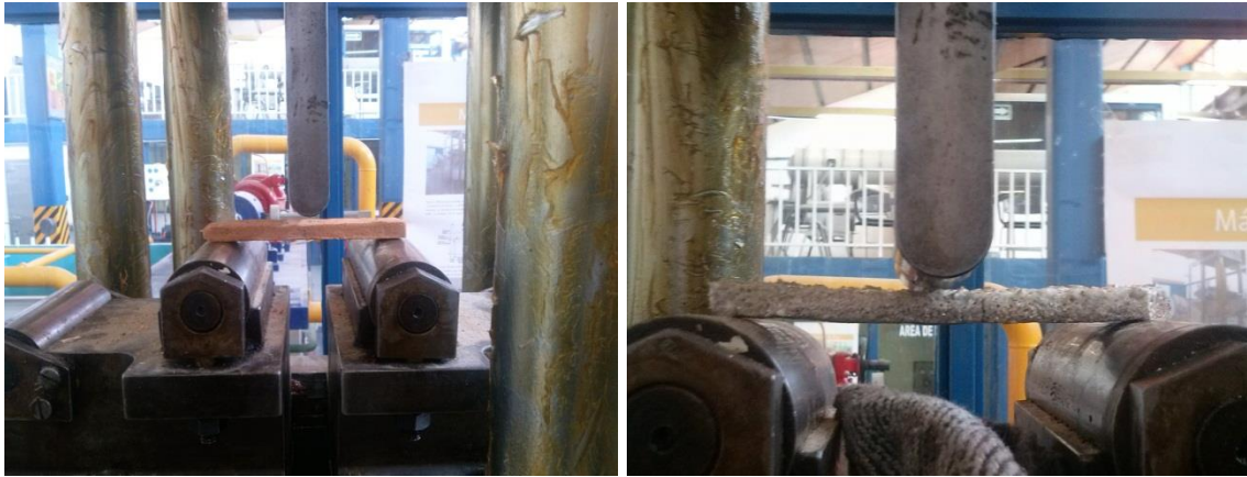
Figura 25. Pruebas para determinar el módulo de ruptura.
