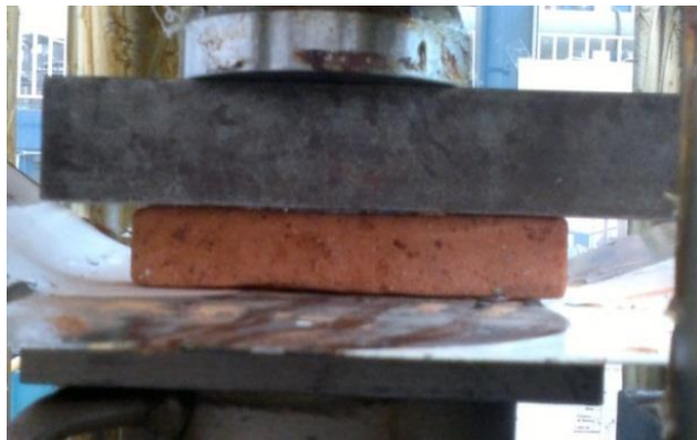
Figura 21. Prueba de compresión a las probetas del arenal.
