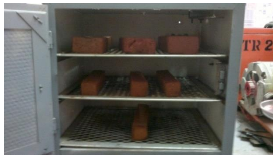
Figura 20. Ladrillos en la primera entrada al horno.
