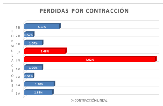
Figura 33. Pérdidas por contracción.
