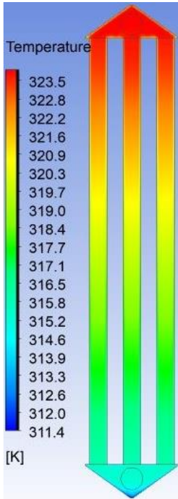
Ilustración B 5. Corte transversal central-Tubulares (5, 33, 61).
