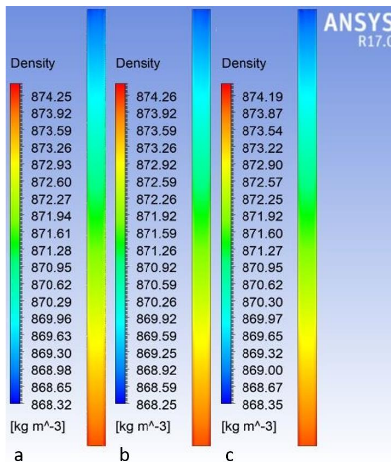
Figura 73. Distribución de la densidad del Tubular 1(a), Tubular 14(b) y Tubular 28(c).
