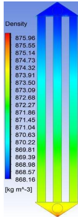
Ilustración C 27. Corte transversal central-Tubulares (27, 55, 83).
