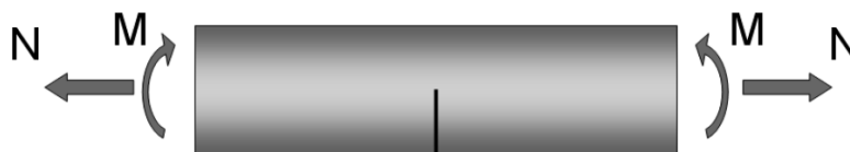
Figura 1. 1 Eje fisurado sometido a flexión y tracción
