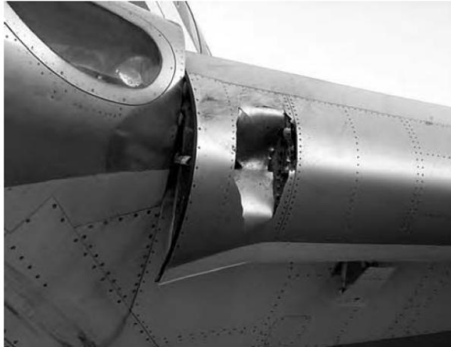
Figura 1. 3 Fractura de la chapa de un ala de un jet de pasajeros [1.16]
