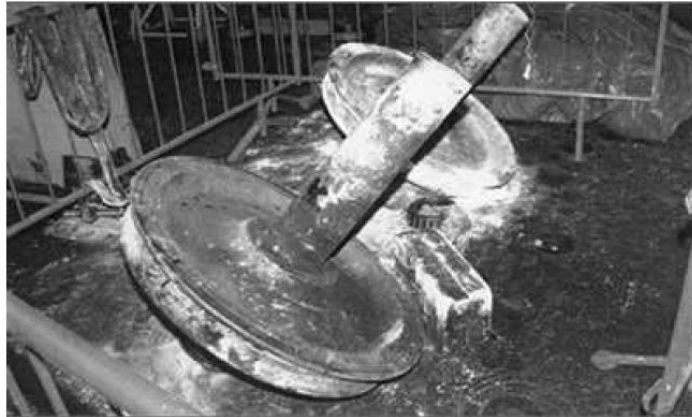
Figura 1. 5 Eje fracturado del tren de mercancías involucrado en un accidente en Richerscote, UK en 1996 [1.17]
