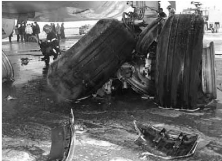
Figura 1. 4 Fallo en el tren de aterrizaje de un avión de pasajeros como consecuencia de la fractura del eje [1.16]
