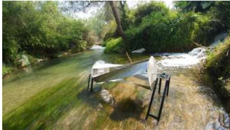
Figura 4.8. Turbina 4 hélices perfil curvo tamaño real propuesto.
