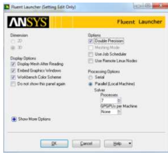
Figura B.10 Parámetros iniciales (Fluent Launcher)
