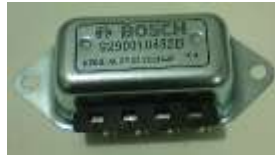
Figura 4.10. Regulador de voltaje
