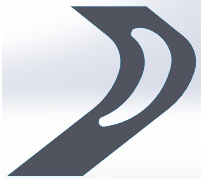
Figura 3.5 Parte del dominio correspondiente al rotor.
