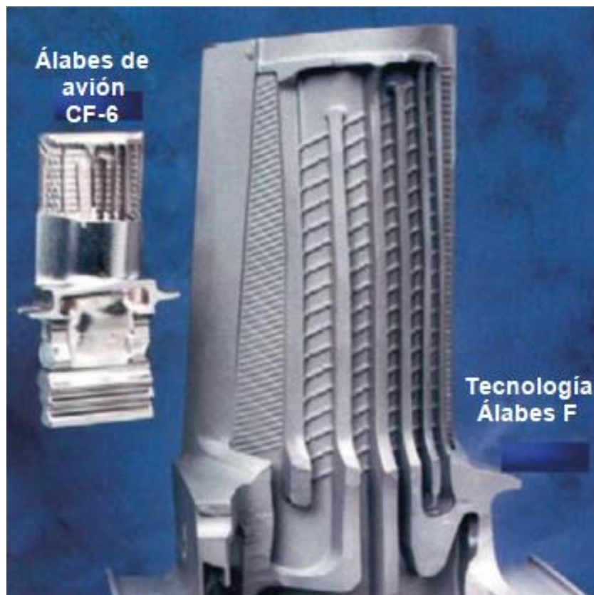
Figura 2.13 Interior de álabes GE FA, que muestran los canales de enfriamiento [20].
