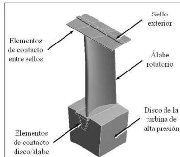
Figura 4. Modelo tridimensional del álabe móvil de la primera etapa. Se muestra la interacción entre los diversos elementos en su montaje.
