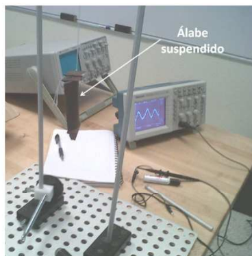
Figura 5. Montaje experimental para obtener las frecuencias naturales del álabe en una condición libre-libre.
