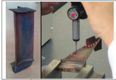
Figura 1. Álabe móvil de la primera etapa. Proceso de medición del perfil
