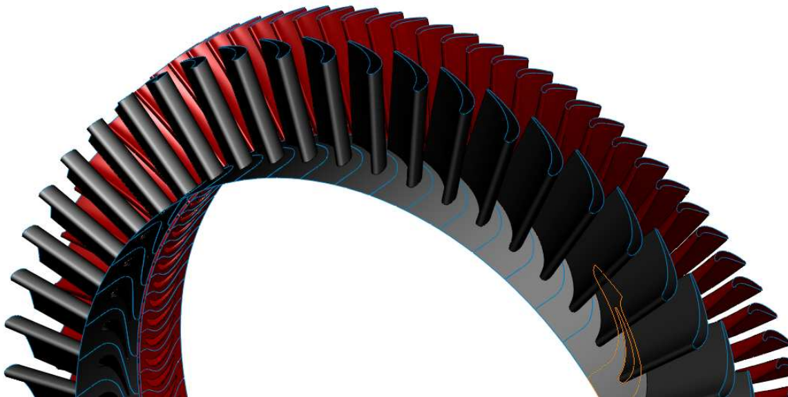
Figura 3.12 Ensamble tobera-álabe. Se muestra solo la superficie sobre los álaves.
