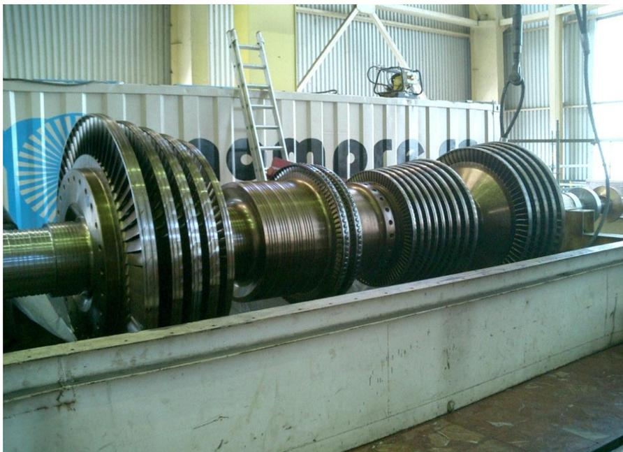
**Fig. 1. 1** Turbina de vapor de flujo bifásico de un generador de electricidad
