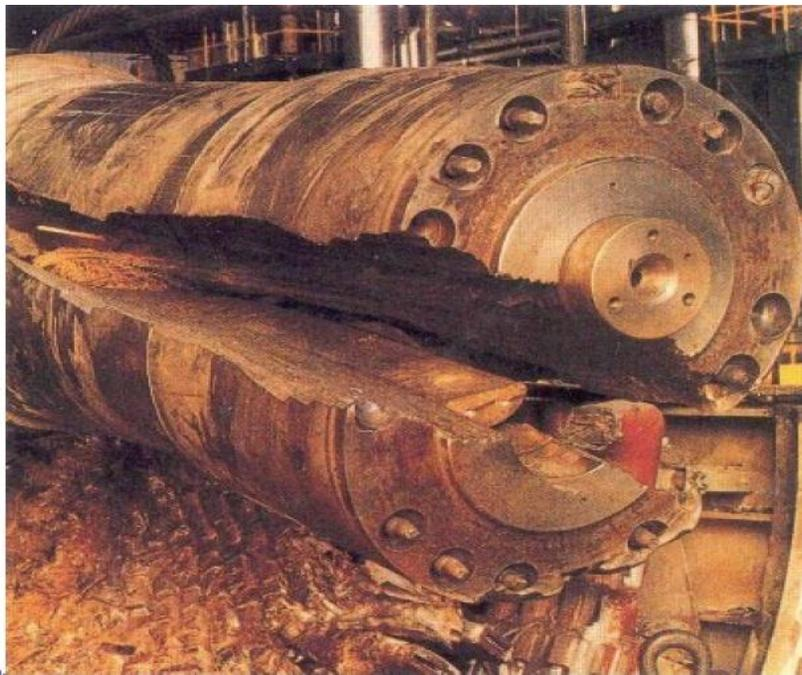
**Fig. 0.2** Rotor colapsado debido a la presencia de fisuras de turbina de vapor de la planta Gallatin Tennessee E.U. Junio 14 de 1974 [0.1]
