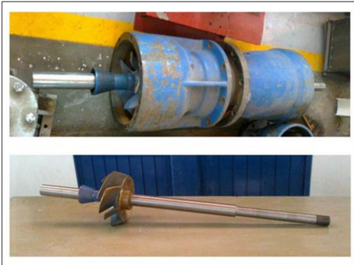
**Fig.6.1** Rotor de la bomba vertical VIC-120HH-1P. Se muestra el rotor montado en parte de la carcasa y el rotor sin la carcasa
