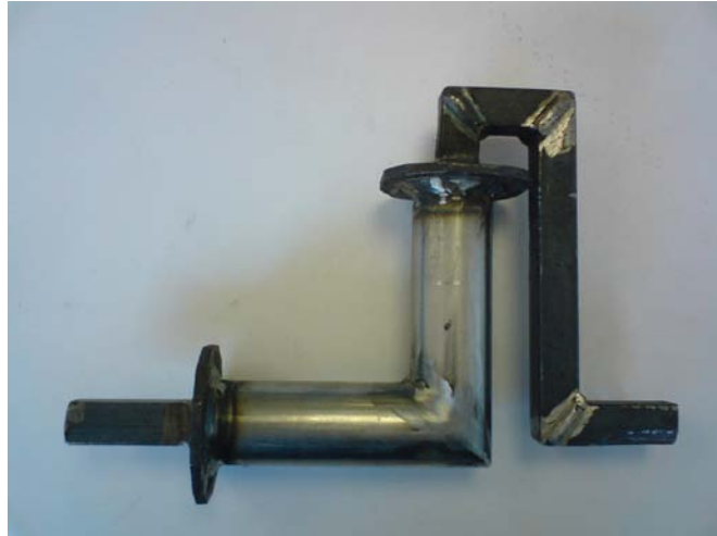
Figura 5- 1. Espécimen de prueba, incluye la junta y su dispositivo sujeción.
