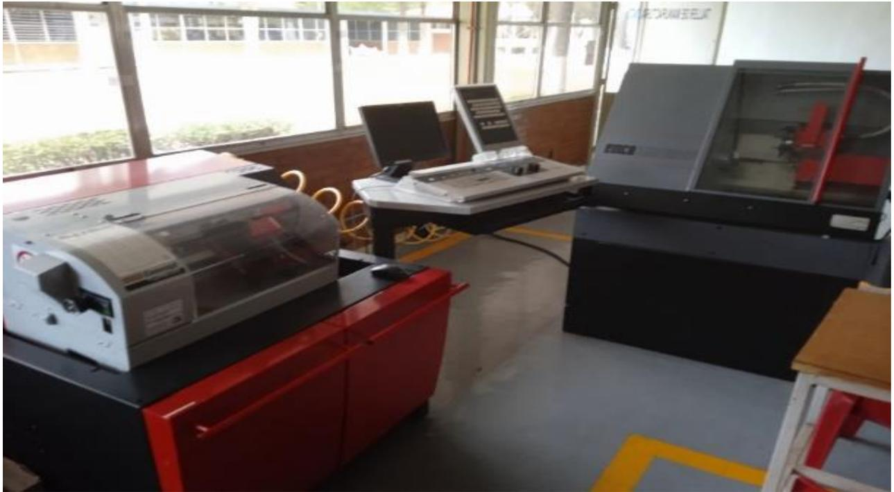
Se proporcionó Mantenimiento preventivo a Torno TURN 55 CNC-2X , el cual consistió en revisión, diagnóstico, prueba y reparación menor de componentes. No incluye refacciones.
