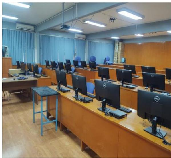
En el Aula Didáctica se realizó la Instalación y se puso en marcha de un switch de 14 puertos colocando base en muro, 03 Access Point con señal de internet en techo del laboratorio y 24 cpu configurando el disco duro monitores y conexiones. Incluye instalación eléctrica, cableado para acceso a internet, y colocación de candados de seguridad a cada CPU.
