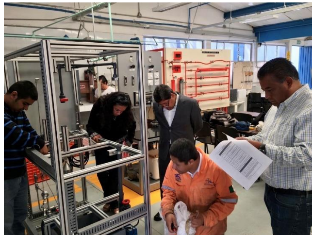
Figura 32. Recepción del intercambiador de calor de coraza y tubos a pequeña escala.
